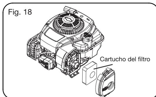
Si el filtro de aire está sucio, se reduce el rendimiento del motor debido a la restricción del aire al carburador. Si el aire contiene mucho polvo, será necesario comprobar con más frecuencia el filtro de aire.
