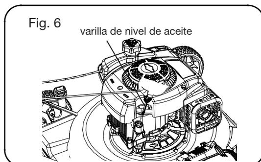
2. Quite la varilla y compruebe el nivel de aceite: el nivel de aceite debe estar entre las marcas "Min." y "Max." de la varilla. Si está cerca del nivel mínimo, llene hasta el nivel máximo con el aceite recomendado (SAE30 o equivalente). No lo llene en exceso. Limpie el aceite derramado, alinee las nervaduras del tapón con la ranura de la boca de llenado y, a continuación, gírelo para cerrarlo con seguridad (ver Fig. 7).
